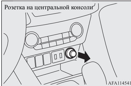
Розетка на напольной консоли
